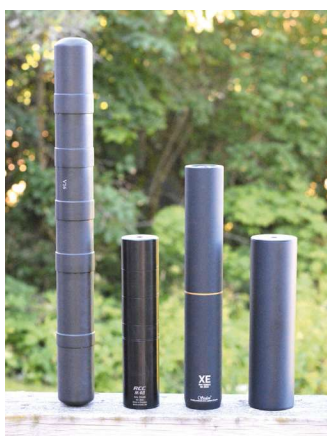
De fyra ljuddämpare som gav bäst ljudreducering, fr VAMC V20 (2:a), RCC M48 (1:a och 3:a), Stalon XE149 (4:a), Jaki Titan Power (5:a)
