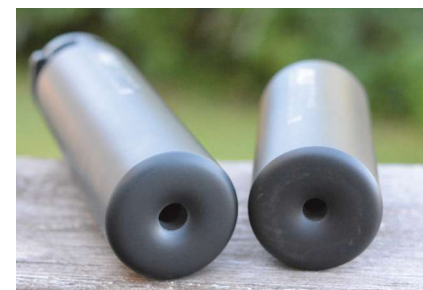
Modellerna från ASE Ultra SL7 och SL5 är utmärkta dämpare. Den stora SL7 var en kombinationsdämpare för .300/.338 därför gav den höga ljudnivåer i kaliber .30. Notera det stora mynnigen tv.
