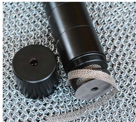
Nedan: I RCC M48 ska bafflarna i varje bromsmodul förse med ett medföljande nät. Detta är säkerligen förklaringen till den utmärkte ljuddämpningen.
