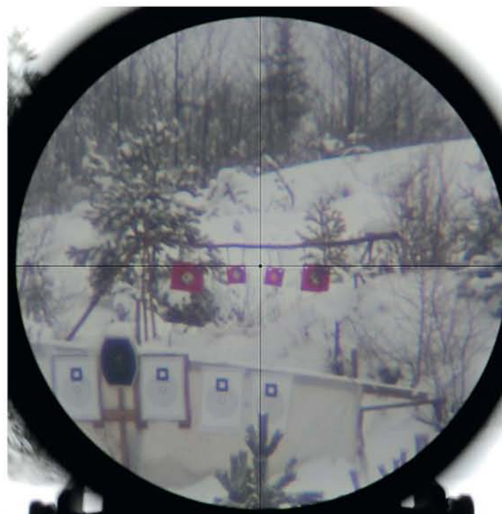
Modellen med 8-34x-förstoring hade ett 1/4-moa target dot-riktmedel men kikarsiktet finns med andra riktmedel också.
